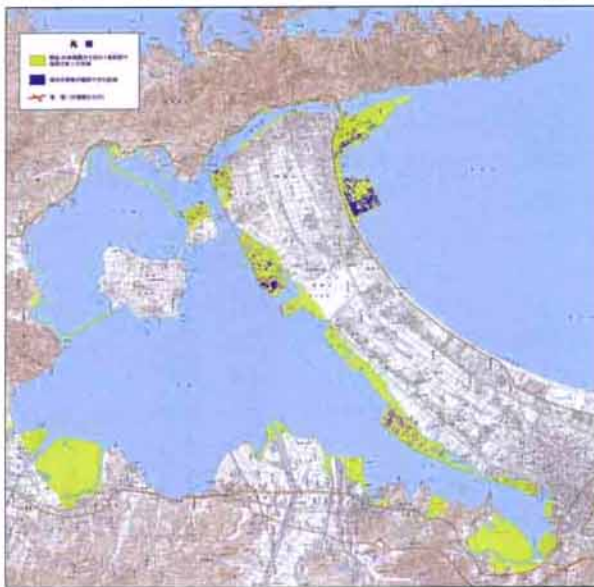
図6 国土地理院地理調査部による液状化被害調査図（国土地理院地理調査部、2000より）。黄色の領域は、明治32年の5万分の1地形図で海域であった地域を示す。青い領域は、液状化現象が確認された区域。
