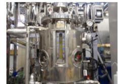
写真1 40L 発酵槽
