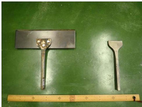
機械の先端部（左：改良後 右：改良前）
