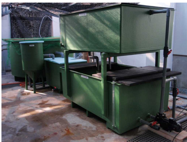
図1 閉鎖循環式陸上養殖水槽 (一番奥が飼育水槽)
