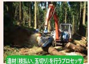
造材(枝払い、玉切り)を行うプロセッサ
