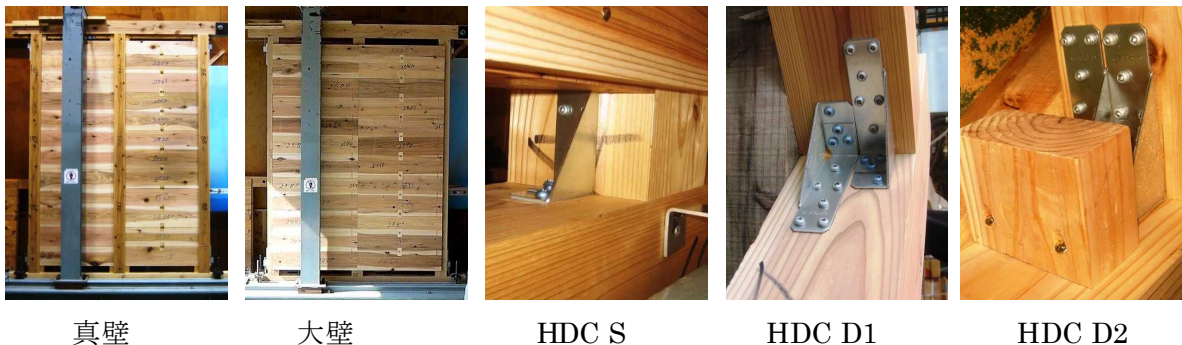
図-1 供試体外観と柱脚の接合方法
