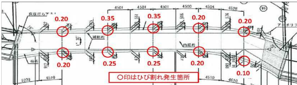
壁高欄ハンチ部
