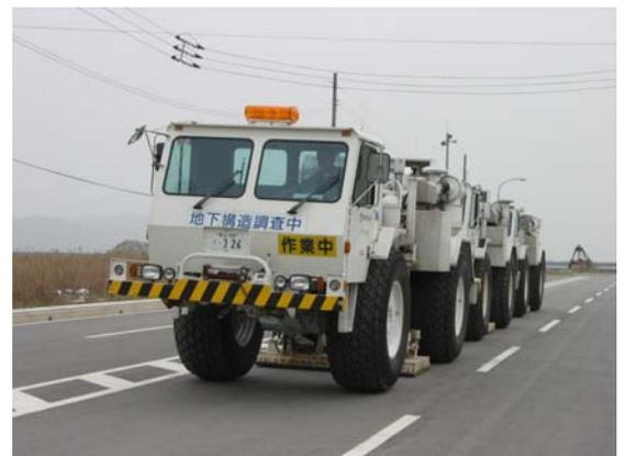
写真3 調査中の大型起振車
