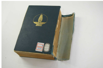
①背表紙が剥落し、製本クロスに包まれた背芯紙が見えている。
