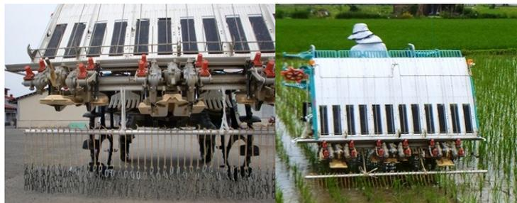
図2 チェーン除草機の田植機への取り付け状況（左）および除草作業の様子（右）
