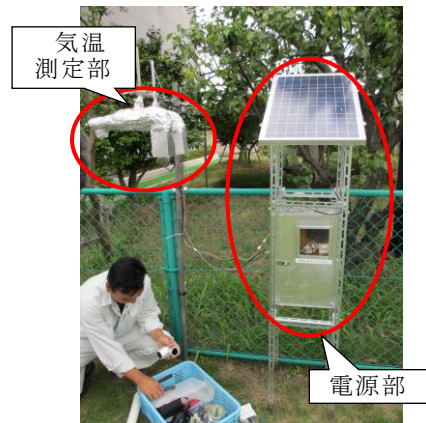
図1 自作通風式気温計の設置状況
